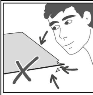
Bahnen auf Materialfehler und Farbgleichheit überprüfen. Bahnen mit sichtbaren Materialfehlern oder Farbabweichungen dürfen nicht verlegt werden.
