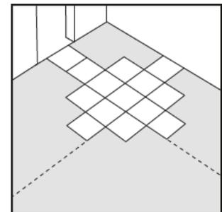
Es ist darauf zu achten, dass alle Fliesen richtungsgleich verlegt werden. Die Atelier Fliesen und Planken müssen richtungsgleich verlegt werden. Die Aufgedruckten Richtungspfeile müssen zwingend beachtet werden.
