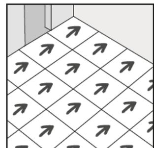
Bei der Verlegung ist es wichtig darauf zu achten, dass der Pol nicht zwischen den Rändern eingeklemmt werden, da dies zur Nahtbildung führt. Falls nötig kann dieser zurückgebürstet werden bevor die Ränder aneinander angelegt werden. Die Fliesen werden Fliesen sind auf Berührung dicht gestoßen, aber spannungsfrei, d.h. nicht press zusammengedrückt, anzulegen. Die entstehenden Kreuzfugen der Stöße müssen ohne Pressung der Fliesen übereinstimmen
