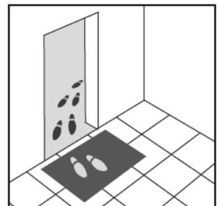
Um eine eventuelle Verschiebung oder Beschädigung zu verhindern muss bei dem Übergang von Teppichfliesen und Planken auf einen anderen Bodenbelag ein Profil verwendet werden.
