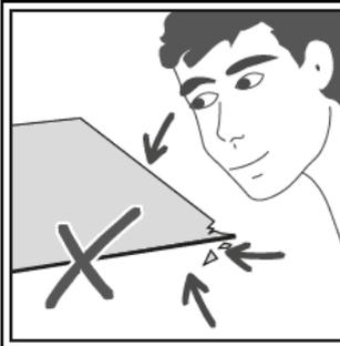
Bahnen auf Materialfehler und Farbgleichheit überprüfen. Bahnen mit sichtbaren Materialfehlern oder Farbabweichungen dürfen nicht verlegt werden.
